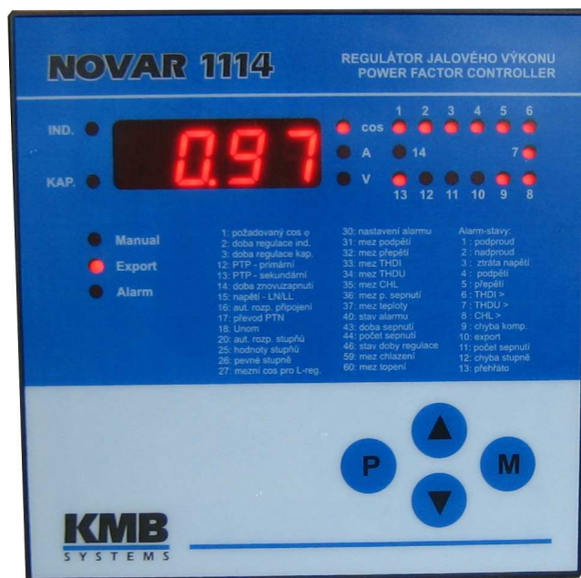
Obr. 1.1 : Novar-114, čelní panel
